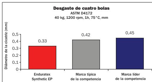
Enduratex Synthetic EP ofrece una excelente protección contra el desgaste comparado con el principal competidor a nivel mundial
